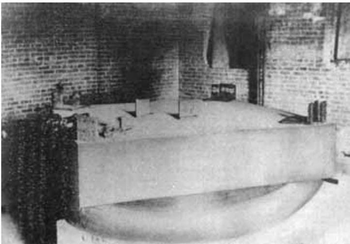
Figura 9. El interferómetro utilizado por Michelson y Morley.
